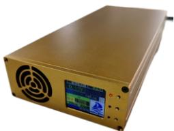
本充电器是一款全新，专为电池储能设计，具有高效率，高功率密度的数字化可调充电器，交流180~264V，直流25.0~38V宽范围电压输入，DC35~103V，0~45A宽电压，电流输出。通过MCU实时监控电源内部、输出负载和输出电压状态，具有AC输入电压电流保护、软启动、热插拔、输出过压保护、输出过流保护、输出短路保护、防反接防倒灌等完善的保护功能。采用全新CNC铝外壳，内置有电流、温控调速功能的风扇进行散热。同时配置有液晶显示屏，可实时监控充电状态，还配备有手动按键调参，蓝牙APP，微信小程序调参。
